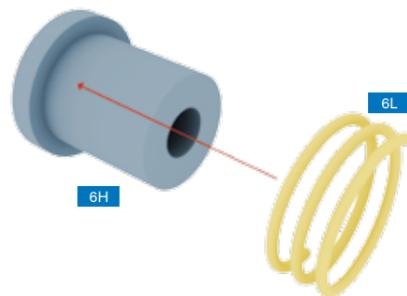
**ШАГ 1** >> Наденьте пружину (6L) на установочную стойку (6H), как показано на рисунке.
