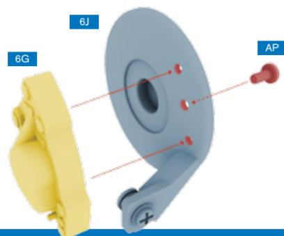
**ШАГ 3** >> Совместите отверстия тормозного суппорта (6G) и тормозного диска (6J). Скрепите винтом AP через центральное отверстие тормозного диска (6J) и свинтите две детали вместе.
