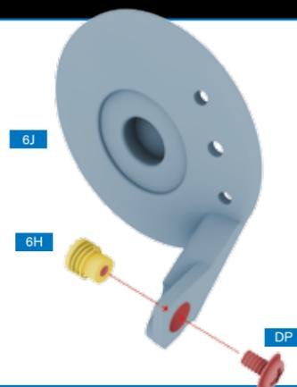
**ШАГ 2** >> Вставьте стойку в сборе в отверстие на конце отвода тормозного диска (6J) и привинтите винтом DP.
