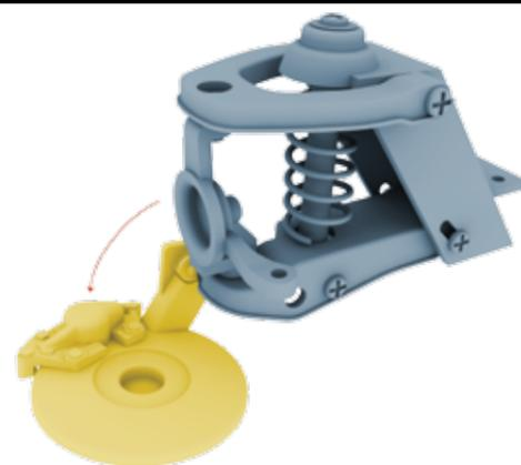
**ШАГ 1В** >> Не притягивайте винт, потому что тормоз в сборе должен двигаться, как показано на рисунке.
